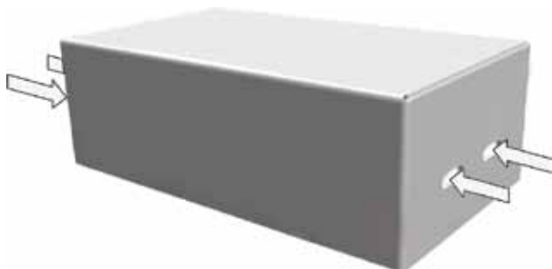
Abb. 4: Transport des Wechselrichters
